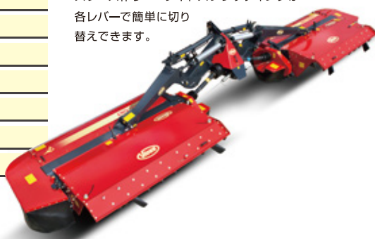
モアユニットを油圧で格納、移動幅は3.0m。
