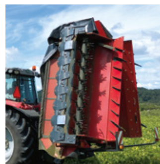
モアユニットを油圧で格納、移動幅は3.0m。
