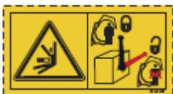
油圧安全ロックが掛かっていない限り、開いているテールゲートの下には絶対に立ち入らないでください。不意にテールゲートが下がり、重大な傷害事故の原因となります。ロックレバーが右向き = 油圧ロック中。ロックレバーが下向き = ロック解除作業状態となります。
