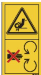
作業中、作業機の回転している部分には絶対に近づかないでください。手足や身体の一部が接触し、重大な傷害事故の原因となります。
