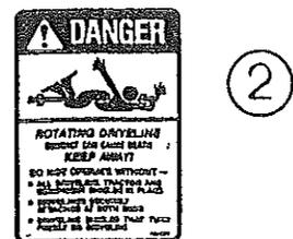
機械の回転部が完全に停止するまで機械に近寄らないでください。回転の停止操作を行った後、すぐには止まらずしばらくの間回転しています。回転中の接触で、傷害事故をまねくおそれがあります。
