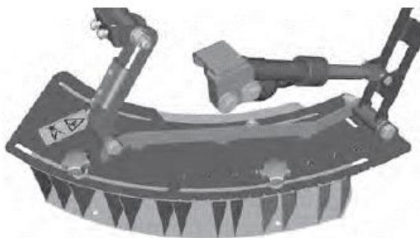
オプションの境界線散布装置のトリムフローはトラクター外部油圧(単動)により通常作業⇒境界線散布作業の切り替えが可能です。散布表を参考に、トリムフローの目盛調整を確認してください。本体のシャッター目盛は散布表を参考してください。最初のトラムライン通路、もしくは畠端から散布幅の半分の位置を走行してください。走行方向はトリムフローの装着されている側で走行してください。
