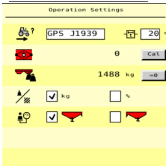
作業を開始する前にキャリブレーションテストを行う必要があります。キャリブレーションテストは左右どちらのディスクでも行うことは可能ですが、トリムフローが装着されていない側で行うとスムーズに行うことができます。本誌では左側でキャリブレーションを行う手順を説明します
